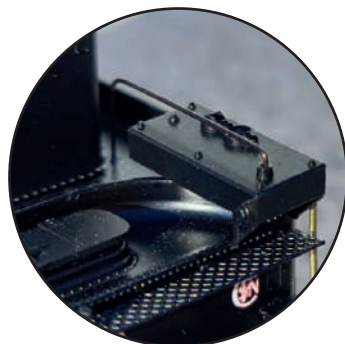
Réservoir à T.I.A sur le tender
