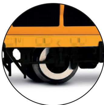
Llantas con discos de freno en cada rueda
