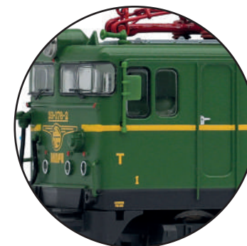
Ventanas frontales y laterales sin reformar
